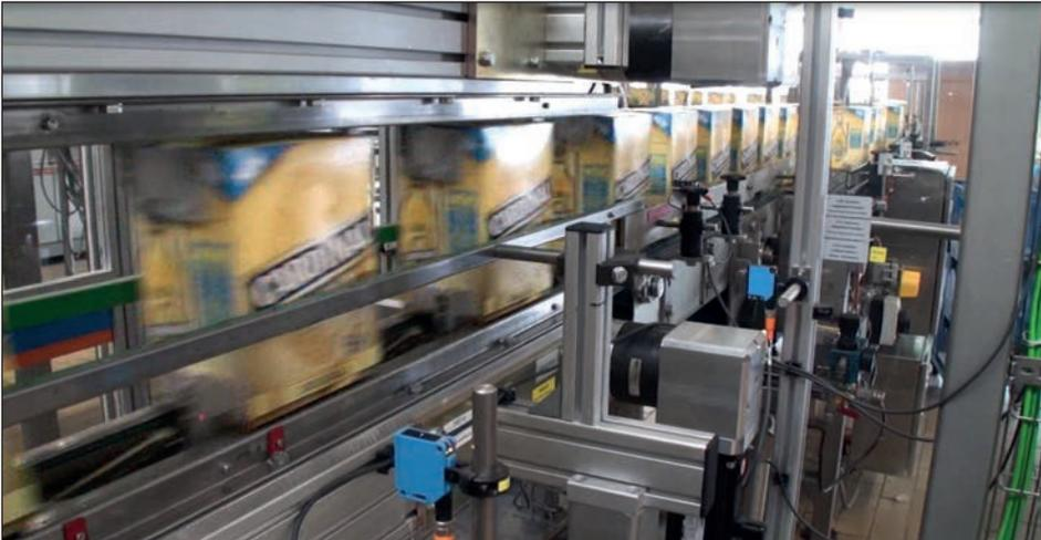
*Automatisches Aufrichten und Verkleben von Steigen*
